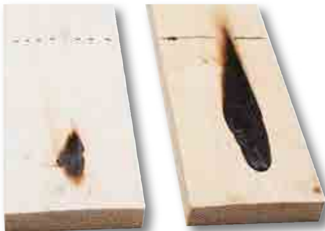
Echantillons de bois traités à gauche et non traité à droite, après 30 secondes d'exposition aux flammes © VTT
