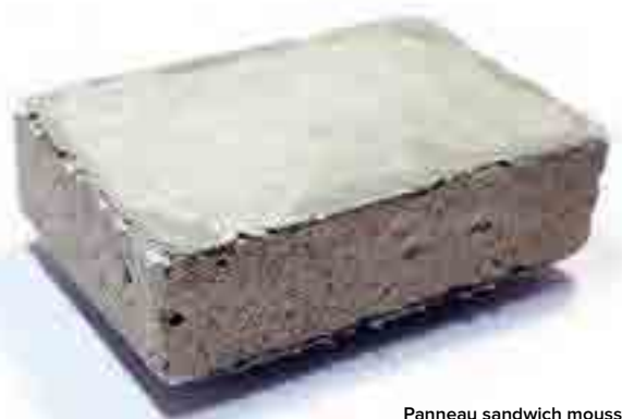
Panneau sandwich mousse de bois/béton fibré - © Fraunhofer WKI
