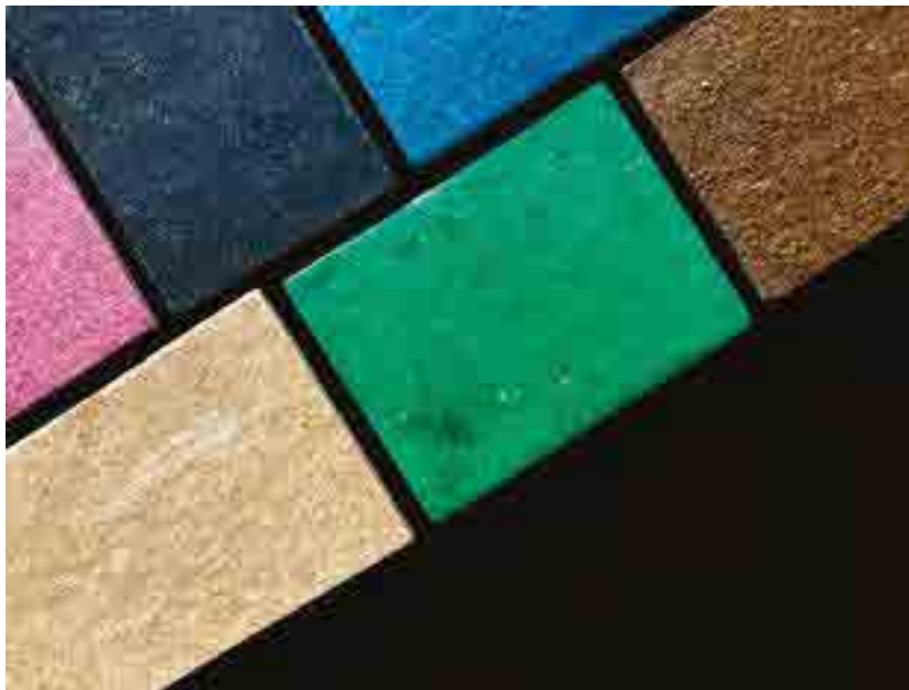
Panneaux de fibres à base de d'épluchures de pommes de terre - © chipsboard
