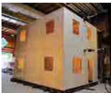
Test de performance sismique sur un bâtiment en CLT - © FPIinnovations
