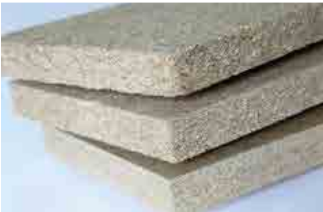
Echantillon de matériaux isolants biosourcés - © Fraunhofer WKI
