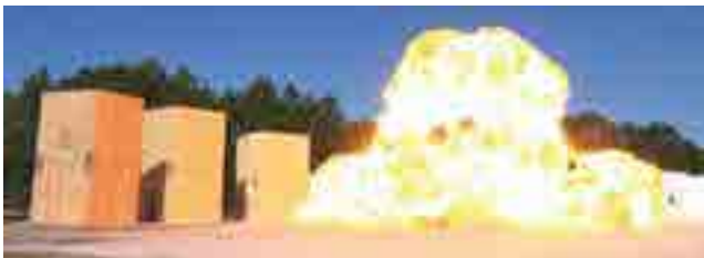
Tests de déflagration sur 3 structures en CLT
