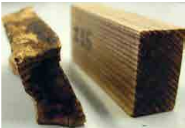
Exemple de bois non traité et traité contre les attaques fongiques © BioCoPol.
