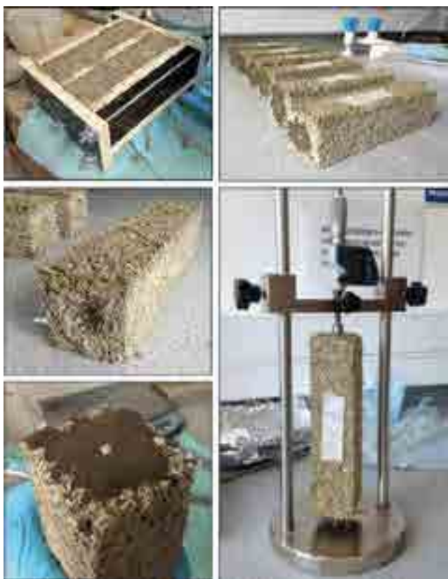
Tests réalisés sur un béton composite chanvre-lin
