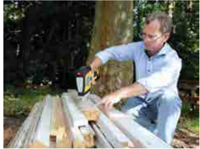
Test de bois usagé par fluorescence à rayons X pour détecter la présence d'agents de préservation inorganiques du bois - © Institut Fraunhofer
