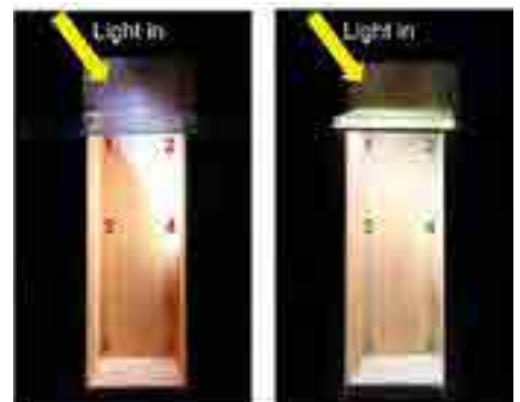
Simulation de la diffusion de la lumière à travers un panneau de bois transparent
