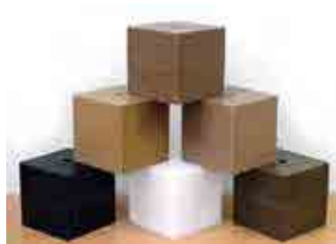
Pièces réalisées en rotomoulage, avec différentes fibres naturelles.
